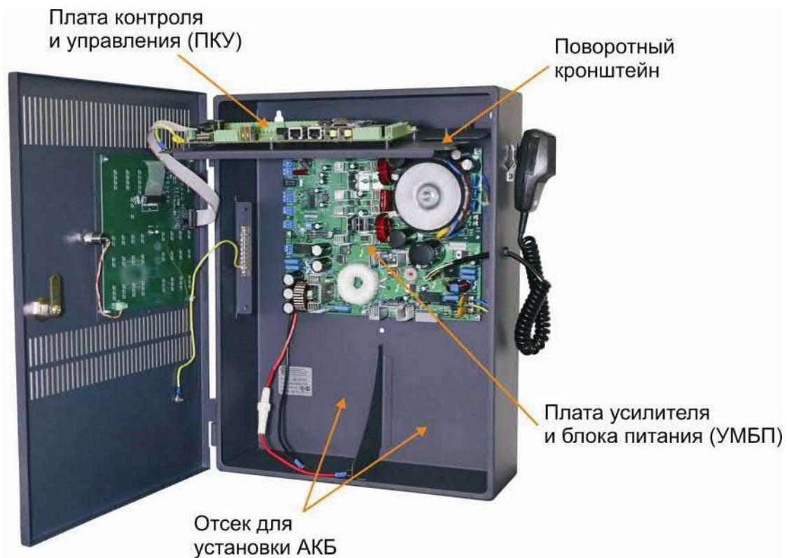
Рис.4б. Внешний вид ППУ AL-8MP2 с откинутым поворотным кронштейном.
