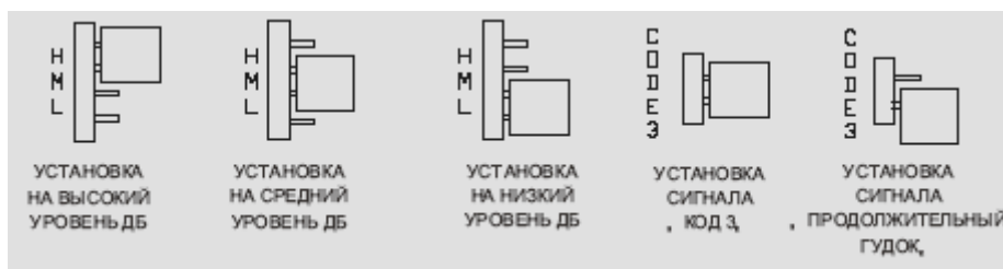
Рис 4: Установка переключек для высокого, среднего и низкого уровня звукового давления, а также звукового сигнала код 3 и продолжительного звукового сигнала.
